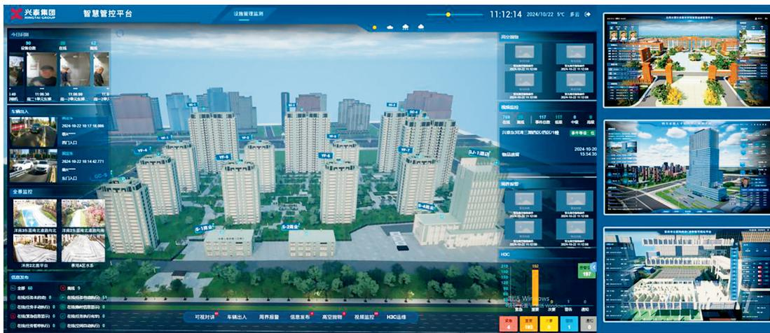
字孪生模型中,实现对建筑实时实景的动态监控。采用“1+1+1+N”的总体架构,打造含一库、一底座、一张图、N应用的建筑智慧管控体系。
